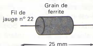
Figure 13-13 Grain de ferrite équivalant à une bobine d'inductance de 20 \mu H à 10 MHz.
