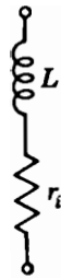
Figure 18-23 La résistance interne en courant continu r_i est en série avec l'inductance de la bobine.
